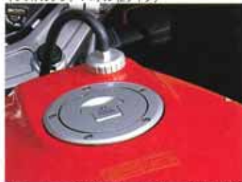
フィルターキャップ&ブリーザー機構(写真はZタイプ)
