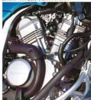
※スリムでパワフルな水冷4サイクルVツインエンジン
