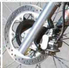
■276mmのフロントディスクブレーキ ■大型化されたナックルガード
