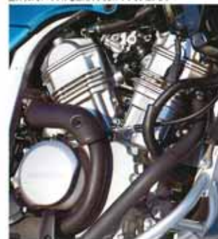
図2スリムでパワフルな水冷4サイクルVツインエンジン
