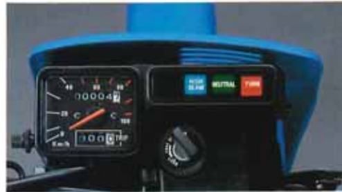
●機能的に配置され、見やすいメーターとインジケータランプ。便利なステアリングロッカー一体式メインスイッチ。
