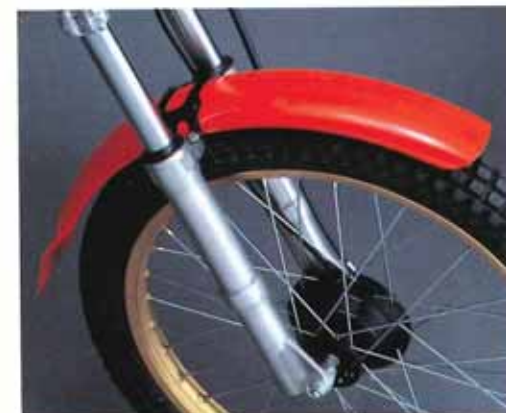
●軽量・高剛性を両立。スタビライザー兼用フロントフェンダー・ステーと、マッドガード兼用フロントフェンダー。
