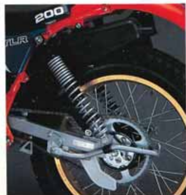
●リアフォーク取付けサイドスタンド。 リアフォークと同じ動きで障害物を避ける。
