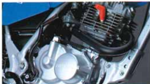
●フレキシブルなパワー特性を誇る、新設計4サイクル・OHCシングルエンジン。
