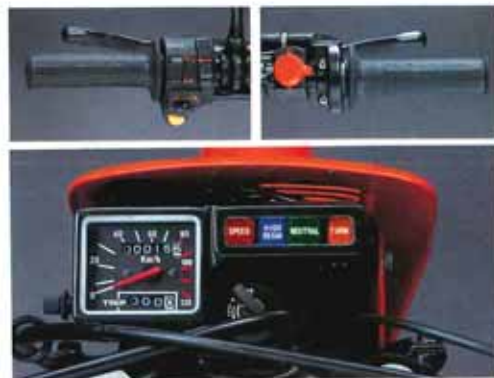
●操作性を追求したスイッチ類のレイアウトと、ハンドルまわりのマスを軽量化する小型メーター。
