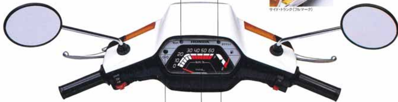
ウインカーパイロットランプ/打音式アラーム 点滅とまろやかな音で誤し忘れを防止します。
