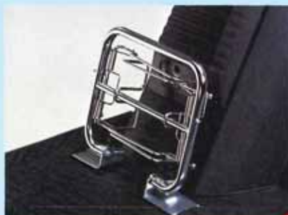
アンダーキャリア 08104-GE100 標準価格 ¥4,400 (取付工賃は含みません) 小型の荷物の運搬に便利です。 自在に動くステーで荷物を固定します。(取付時間0.7H)
