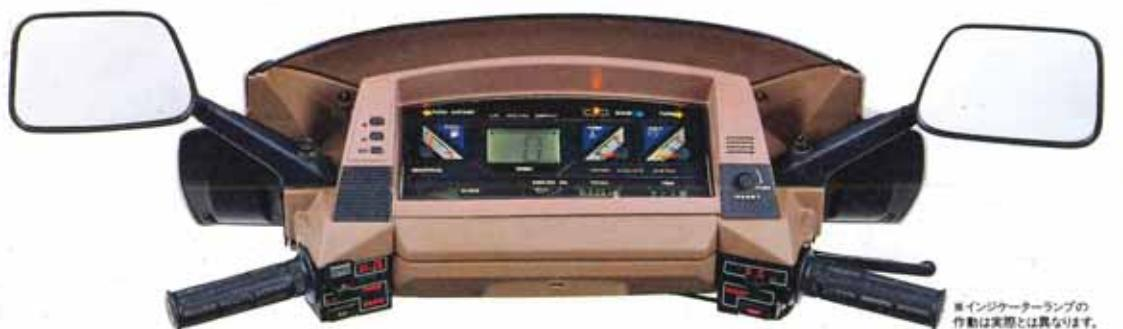
●マイコン内蔵・液晶デジタルスピードメーター：数字は大きく読みやすく、太陽光の直射状態でも、夜間時でもはっきりと確認できます。目的地までの所要時間などがひと目でわかるデジタルクォーツ時計付です。
