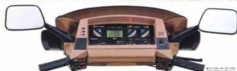
●マイコン内蔵・液晶デジタルスピードメーター：数字は大きく読みやすく、太陽光の直射状態でも、夜間時でもはっきり確認できます。目的地までの所要時間などひじ目でわかるデジタルクロック時計付です。
