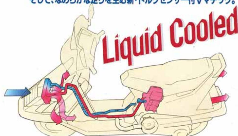
11馬力のパワフル出力。しかも水冷ならではの静粛性を誇る、新・水冷4サイクルエンジン。中・低速域を重視した扱いやすさと、 $70\text{km}/\ell$  の低燃費をも実現しています。冷却は、かずかずの新機構をコンパクトにまとめ、ボディ前面に新設計小型軽量ファン付のラジエーターを配した水冷方式。安定した4サイクルパワーを発揮します。（※2名乗車時・50km/h定速走行テスト法）
