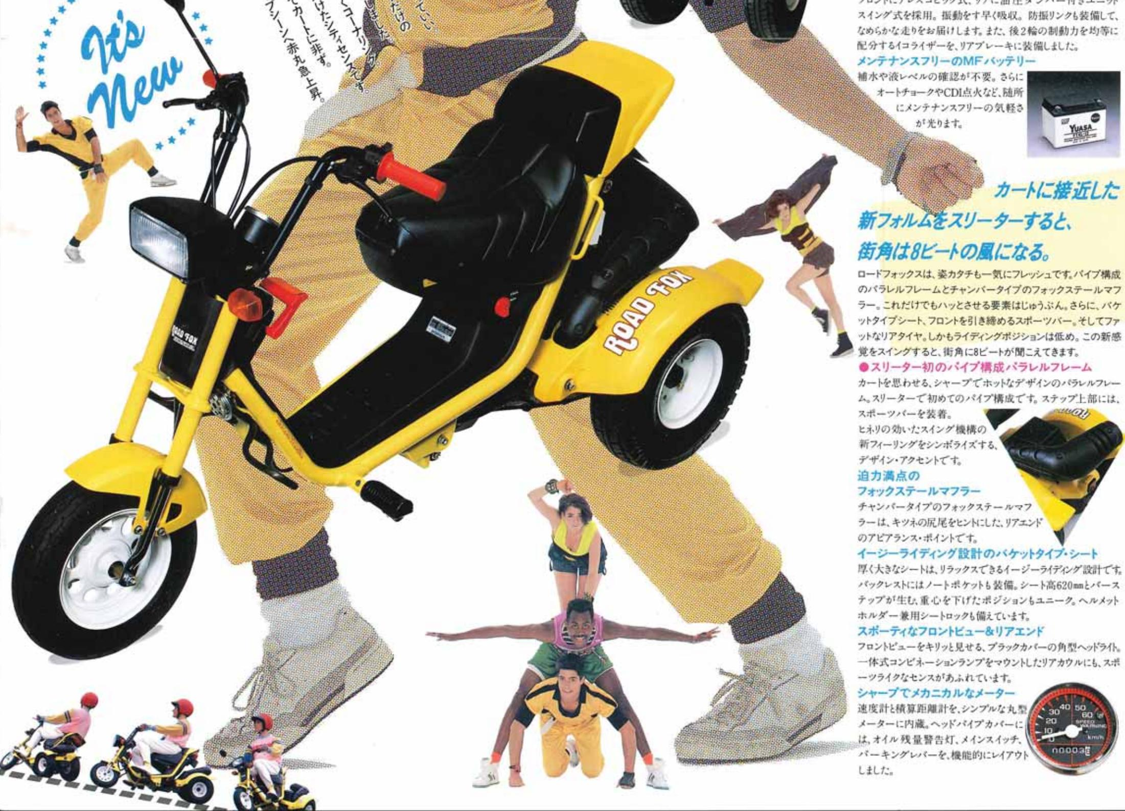
フロントにアレスコピック式、リアに油圧ダンパー付きエアートスイング式を採用。振動をすばく吸収。防振リンクも装備して、なめらかな走りをお届けします。また、後2輪の制動力を均等に分配するイコライザーを、リアブレーキに装備しました。
