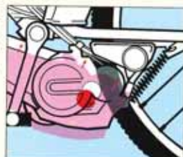
パワー走行時にローラー（赤丸）がタイヤに密着する。
