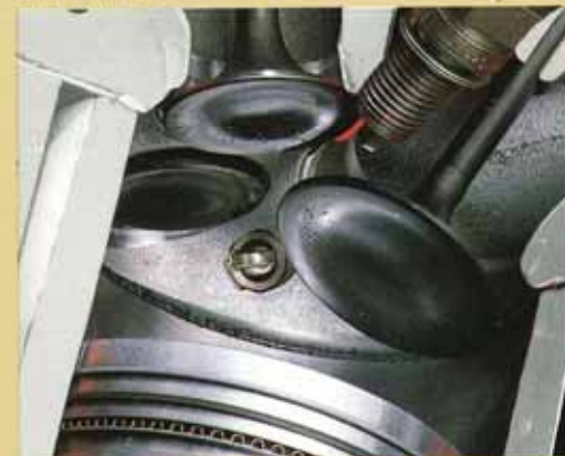
インテーク2個、エキゾースト1個の3バルブ方式。さらにホンダ独自の2プラグ方式によるユニークなシステム。
