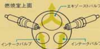
インテーク2個、エキゾースト1個の3バルブ方式。さらにホンダ独自の2プラグ方式によるユニークなシステム。
