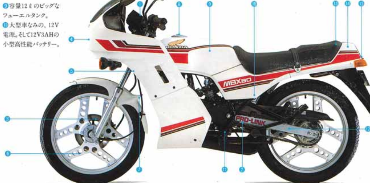
⑫高張力鋼板を使用、強度アップした角型断面リアスイングアーム。
