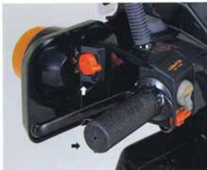
グリップヒーター (左・右セット) (取付時間0.4H) 08568-GG200 標準価格 ¥9,000 (取付工賃は含みません) ハイ、ロー2段切り換え式のヒーター。 ハンドルを握る手がじんわりとアツクカイノ
