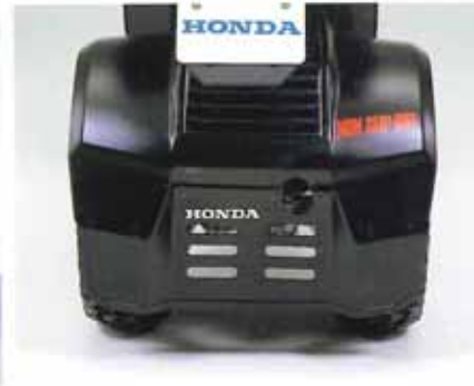
リアマッドガード (取付時間0.2H) 08156-GG200 標準価格 ¥2,200 (取付工賃は含みません) 大型のヘビーデューティ設計。ボディ への泥や雪のハネ上がりを防ぎます。
