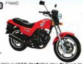
●空冷4サイクルDOHC4バルブ4気筒・136mm・21PS/10,500rpm・1.1kg/m<sup>2</sup>/9,500rpm・6段リターン・燃費40km/l・乾重量120kg・シート高73cm・前輪油圧式ディスクブレーキ・デュアルディスクブレーキ
