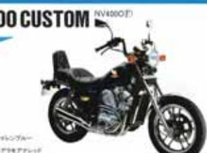
●空冷4サイクルDOHC4バルブ4気筒・128mm・43PS/10,500rpm・1.1kg/m<sup>2</sup>/9,500rpm・6段リターン・燃費40km/l・乾重量184kg・シート高79cm・前輪油圧式ディスクブレーキ・デュアルディスクブレーキ・デュアルエアスクリーン・フロントフォーク・ブレーキホース固定型アンチダイブシステム
