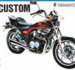
●空冷4サイクルDOHC4バルブ4気筒・136mm・40PS/10,500rpm・1.1kg/m<sup>2</sup>/8,500rpm・6段リターン・燃費40km/l・乾重量180kg・シート高78cm・前輪油圧式ディスクブレーキ・デュアルディスクブレーキ・デュアルエアスクリーン・フロントフォーク・ブレーキホース固定型アンチダイブシステム・キックスターター
