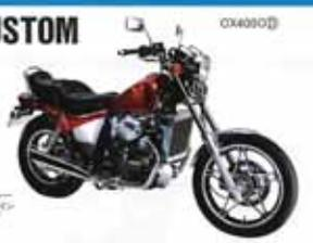
●空冷4サイクルDOHC4バルブ4気筒・136mm・40PS/10,500rpm・1.1kg/m<sup>2</sup>/7,500rpm・6段リターン・燃費40km/l・乾重量184kg・シート高79cm・前輪油圧式ディスクブレーキ・デュアルディスクブレーキ・デュアルエアスクリーン・フロントフォーク・ブレーキホース固定型アンチダイブシステム
