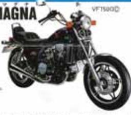
●空冷4サイクルDOHC4バルブ4気筒・148mm・70PS/7,500rpm・1.1kg/m<sup>2</sup>/7,500rpm・6段リターン・ODアプ・燃費36km/l・乾重量211kg・シート高72.5cm・前輪油圧式ディスクブレーキ・デュアルディスクブレーキ・フロントエアスクリーン・リアエアスクリーン・フロントフォーク・ブレーキホース固定型アンチダイブシステム・VTRハイパーチャージャーシステム・キックスターター
