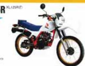
●空冷4サイクルDOHC4バルブ4気筒・124mm・12PS/10,500rpm・1.1kg/m<sup>2</sup>/7,500rpm・燃費50km/l・乾重量109kg・シート高80cm・前輪油圧式ディスクブレーキ・デュアルディスクブレーキ
