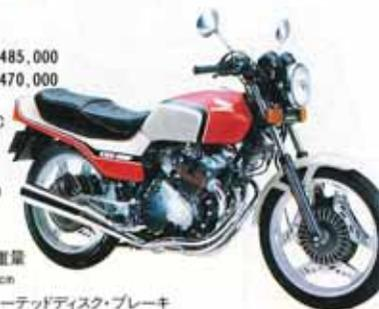
●空冷4サイクルDOHC4バルブ4気筒・399cc ●48PS/11,000rpm ●3.4kg-m/9,000rpm ●6段リターン ●燃費40km/ℓ(60km/h定地走行テスト値) ●乾燥重量173kg ●シート高77.5cm ●インボード・ベンチレーテッドディスク・ブレーキ ●ブレーキトルク応答型アンチダイブシステム ●フロント・エアサスペンション ●プロリンク・リアサスペンション ●ブーメラン型コムスターホイール
