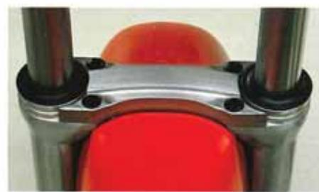
ドホールディングを高め、一方、路面の細やかな起伏やダートの凸凹による振動には減衰力が弱まり、衝撃をソフトに吸収。「機敏な操縦性」と「快適な乗り心地」という相反する条件を巧みに両立させています。そのうえ、ライダーの好みに合わせてスプリングの硬さを5段階に調節できるアジャスター付機構付。しかも、このダンパーを倒立型として、バネ下重量の軽減を図った入念な設計です。
