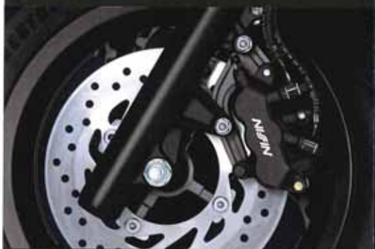
小型・軽量トリプルピストンキャリパー装着φ240mmフロントディスクブレーキ。
