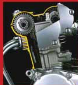
エンジンは4バルブ・DOHC（デュアルオーバーヘッドカム）4バルブ構造で、空冷式で、総排気量49cm 3 、最高出力5.6PS/10,500rpm、最大トルク0.42kgm/8,500rpm。
