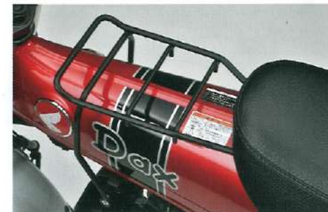
キタコ センターキャリア 社外品 OSS-ZH-12336000 - ¥9,350(¥8,500) 許容積載量:0.5kg。 材質:スチール製、ブラック塗装。 取付時間 0.3H。
