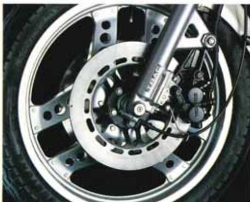
ーを装着しました。2個のピストンを持つ、このユニークなシステムはパッド面積が大きく、スムーズかつ強力な制動効果を発揮。しかも、ピストンが小さく、ディスクキャリパーの軽量化を実現しているため、バネ下重量の軽減にも役立っています。
