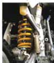
●多様な路面状況に頼もしく対応す るリザーバタンク付き分離加 圧式リアクッション。 ※撮影のため、カバーをはずしてあります。
