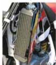
●ルックスも性能も本格派。熱交換 タイプのサーモスタット付き2コア ・アルミラジエーター。 ※撮影のため、カバーをはずしてあります。
