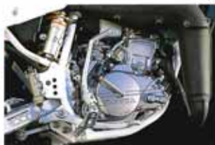
●あつたやすいタフな水冷2サイクル単気筒エンジン。
