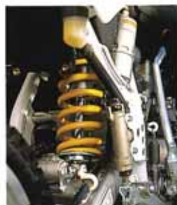
●多様な路面状況に頼もしく対応するリザーバータンク付き分離加圧式リアクッション。 ※撮影のため、カバーをはずしてあります。
