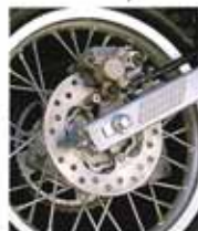
●フロントとのコンビネーション抜群。 油圧式リアディスクブレーキ。
