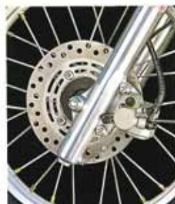
●安心感あふれる効きとタッチを実現。油圧式フロントディスクブレーキ。
