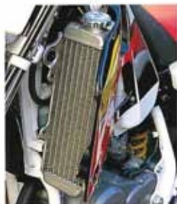
●ルックスも性能も本格派。無塗装タイプのサーモスタット付き2コア・アルミラジエーター。 ※撮影のため、カバーをはずしてあります。
