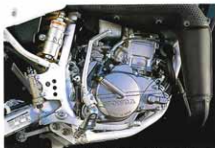
●あつかいやすくタフな水冷2サイクル単気筒エンジン。
