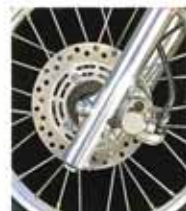
●安心感あふれる動きもタッチを 実現。油圧式フロントディスク ブレーキ。
