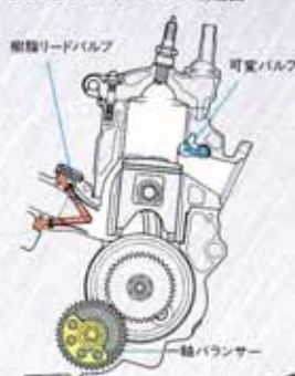
クランクケースリードバルブ構造図
