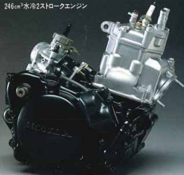
246cm 3 水冷2ストロークエンジン
