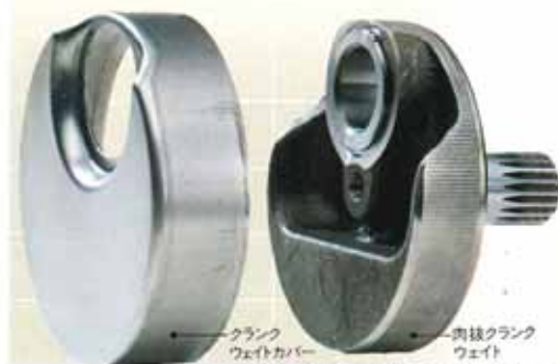
効果的な肉抜きを図った軽量クランクウェイト。
