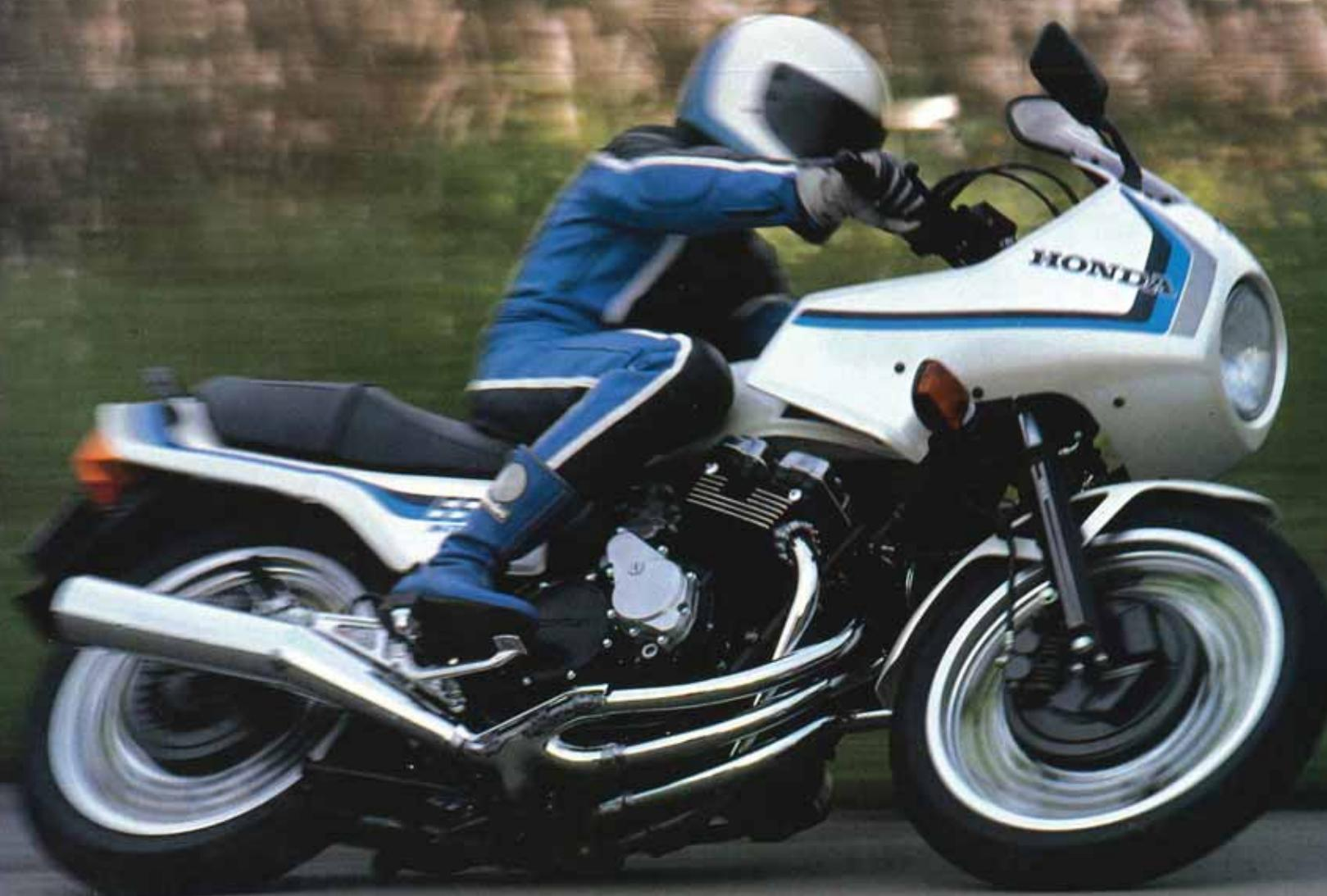
最高出力60PS/10,000rpm。最大トルク4.7kg-m/8,000rpm。乾燥重量190kg。そして
