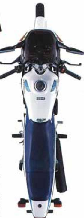
軽快な取りまわしと機敏な走りのベーシック。125ccクラス並みの専用設計コンパクトフレーム。マシンの基本パーツであるフレームから軽量化を徹底したCBX250S。リジットマウント方式をはじめ、フレーム各部にコンパクト化を追求した専用設計セミダブルクレードルフレームは、マシン全体の軽量化に大きく貢献。乾燥重量115kgと250ccオンロードきっての軽さを達成しました。また、シート高も760mmと低く、コンパクトフレームとあいまってすぐれた足着き性を誇ります。
