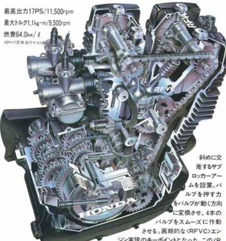
半球型燃焼室は望めなかった。そこで Honda は、4本のバルブを球面に沿わせる放射状配置に着目した。しかし、これまでのロッカーアームで放射状配置のバルブを直接駆動させると、バルブの動く方向に対し斜めに力を加えることになり、高回転域でのトラブルの原因となる。これを解決したのがサブロッカーアームである。カムシャフトと平行する支点を持つロッカーアームに
