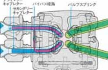
※ 低中速域での混合気の流れ 高速域での混合気の流れ
