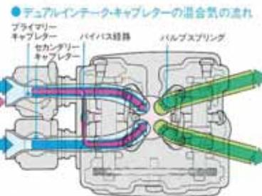
● 中速域での混合気の流れ ● 高速域での混合気の流れ
