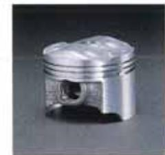
パワーユニットの内部で常に高回転、高圧、高熱にさらされるピストンは、多くの過酷な要件を強いられる。その高性能パワーユニットのピストンの条件とは、まず軽量、高剛性であること。放熱性、気密性、耐磨耗性が良いこと。摺動抵抗や熱変形が少ないことなどが挙げられる。新たに採用されたニュータイプのピストンは、
