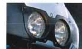
フロントには小径φ100mmのハロゲンヘッドライト(60/35W)をデュアルで装備している。
