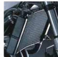
高回転、高性能の追求は、いわば熱との格闘であるといえよう。“ダブルアール”では放熱効果の高いラウンド型ラジエターを採用。パワーユニットの熱を効率よく放熱させ、安定した性能を発揮させることに貢献している。
