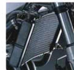
高回転、高性能の追求は、いわば熱との格闘であるといえよう。“ダブルアール”では放熱効果の高いラウンド型ラジエターを採用。パワーユニットの熱を効率よく放熱させ、安定した性能を発揮させることに貢献している。
