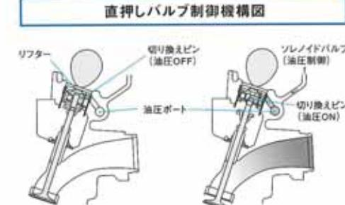
直押しバルブ制御機構図
