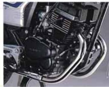
を実現。さらに、長年の実績で培った、定評の低燃費と耐久性を備えています。もちろん、始動はワンタッチのセルスターター。メンテナンスフリーの電子進角式CDIとあいまって、良好な始動性をもたらしています。ホンダの技術と経験により、改良を重ねて完成した、信頼性の高いエンジンです。
