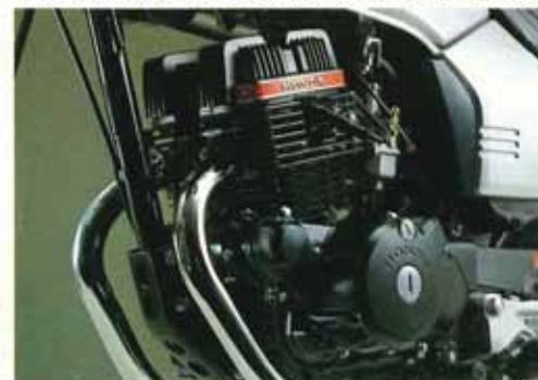
調されています。始動はセルフスターター。点火方式は、強力かつ安定した着火性能を發揮する電子進角式CDI。
