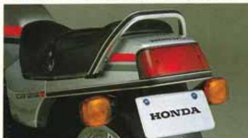
● スタイリングを引き締めるアルミ製サイドグリップとグラブバー。ステップホルダーもアルミ製を採用。
