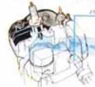
ペダルを踏んだときは、バルブが閉じる
