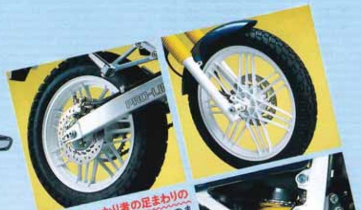
**チェック2(しっかり者の足まわりの話)** 僕らのステージを思いのままに広げてくれる、もう一方の立役者がこの足まわり。まずはストッピングパワー。フロントにデュアルピストンキャリバーのディスクブレーキ。リアにもディスクブレーキを配して、しっかり止まるための準備は万端。21本スポーク・アルミキャストホイールには、専用設計のチューブレスタイヤを履いていて、ワイドな守備範囲で僕らの走りに対応してくれる。そしてリアサスペンションは、足つき性向上のためにスプリングの調整が可能になった。同時にダンパーのセッティングも見直されて、乗り味はゴキゲンそのもの、と感じ。軽量アルミ角断面のスイングアームと、スムーズでフレキシブルな作動で定評のブロリンクとのマッチングも非常によろしい。また、前220mm、後200mmのサスペンションストロークは、オンロードでのソフトで快適な乗り心地と、オフロードでの速い走破力をうまく両立してくれているんだ。自然なライディングポジションといい、取り回しが軽くスリムな車体構成といい、何から何まで、僕ら流ライフスタイルを支える軽快なフットワークは、もお、ホント。
