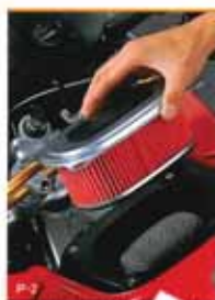
② タンク前面に設置した、メンテナンス性に 優れた大容量エアクリケーシングボックス。
