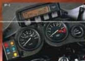
① フロントリップメーター、 サイドステップメーター、 時計、タイマーの機能を持つ 多機能デジタルトリップ メーターを備えたメーターパネル。
